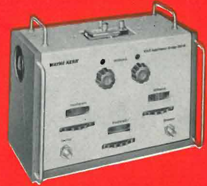
Fig. 8 - Ponte per misure d'ammittenza VHF
